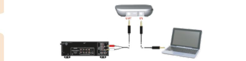
Si vous utilisez déjà l'entrée audio de votre système, vous pouvez utiliser la fonction bypass audio du récepteur via l'entrée ligne au format jack 3.5 mm.
