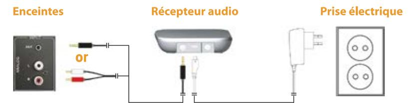
Utilisez un de ces câbles selon le type de connectique de l'entrée auxiliaire
